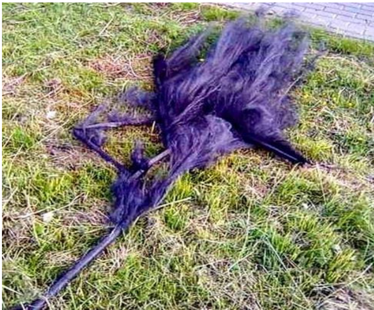
Углепластиковая удочка, после воздействия электрического тока.
